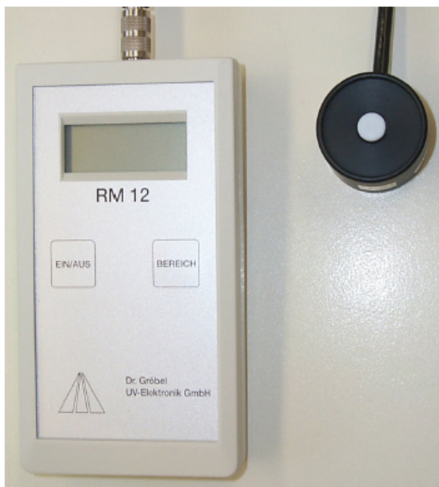
图 1 带传感器的 UV-VIS 照度计 RM-12
